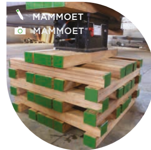
Mammoet vijzelbalken Nederland
