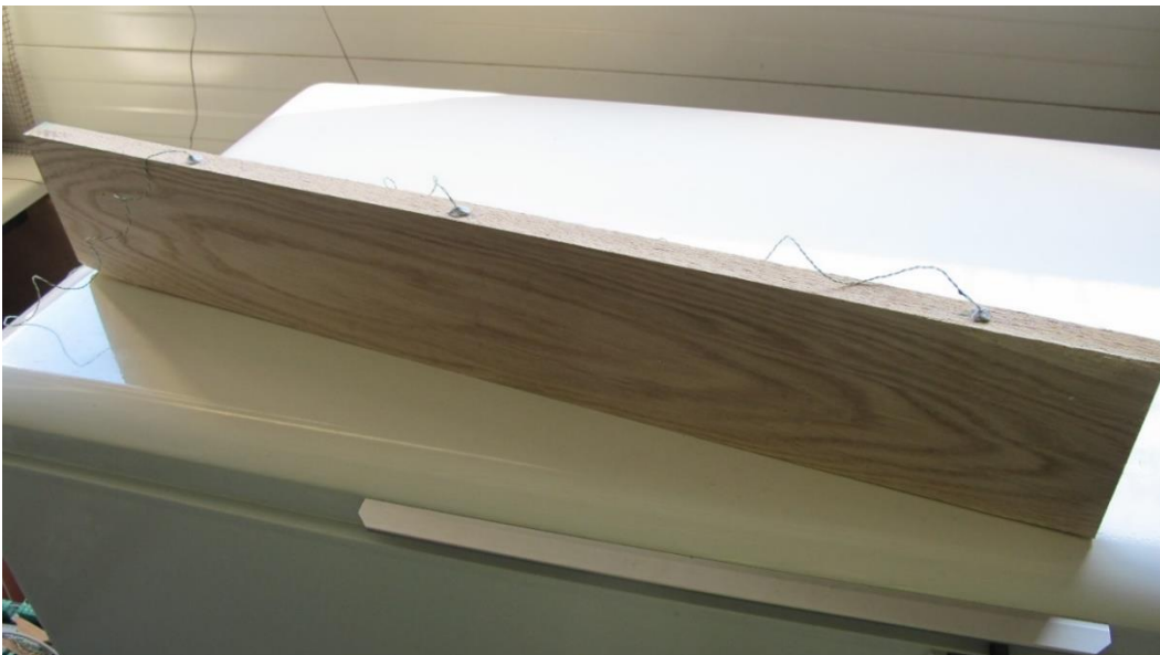
Proefstuk eiken met ingebrachte sensoren (foto: SHR)
